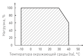
Рис. 1. Максимальная допустимая нагрузка, % от мощности источника.
